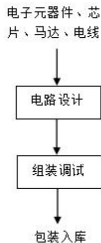
图 2-4 智能控制箱生产工艺流程及排污节点图
